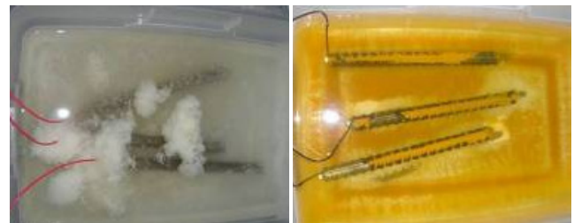
Varilla de refuerzo en 6% Hycrete & solución NaCl Sin daños
